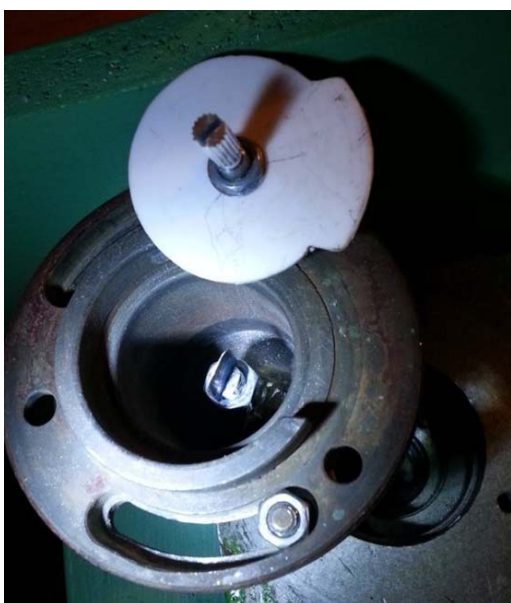
Rys. Przeniesienie ruchu obrotowego kranu hamulca pomocniczego FD1 na potencjometr umożliwiający kompensację ruchu pionowego (blaszka przesuwająca się w szczelinie osi potencjometru).
